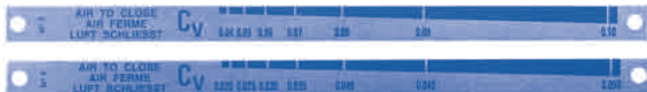
Рис. 5 Шкала C_v для затворов №№ 5 и 6
