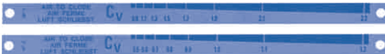
Рис. 4 Шкала C_v для затворов №№ 1 и 2
